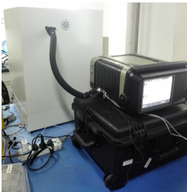
图 21 加热管线及便携式 GC-MS
