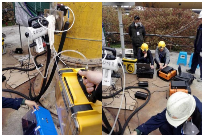
图 1- 2 上海某石化企业污水处理装置的大气固定污染源现场采样和精密度测试
