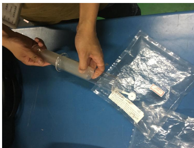
图 33 使用注射器进行样品稀释
