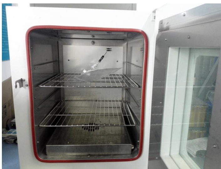
图 20 放置气袋并加热的烘箱
