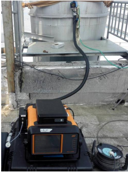
图 18 采用仪器直接进样法采样系统在现场进行实际样品采集
