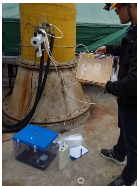
图 16 采用气袋法采样系统在现场进行实际样品采集
