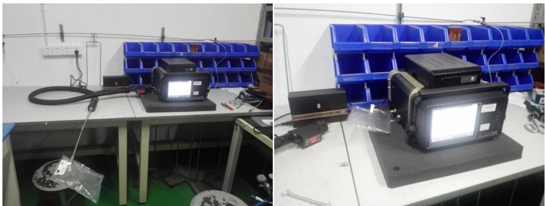
左：（1）气体样品通过加热采样管进入便携式GC-MS分析；右：（2）气体样品直接进入便携式GC-MS分析
