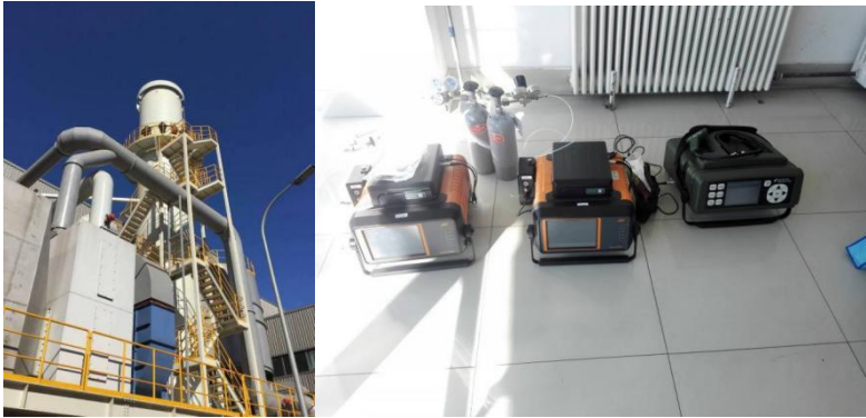
图 1- 1 北京某汽车生产企业喷涂车间大气固定污染源现场采样和精密度测试
